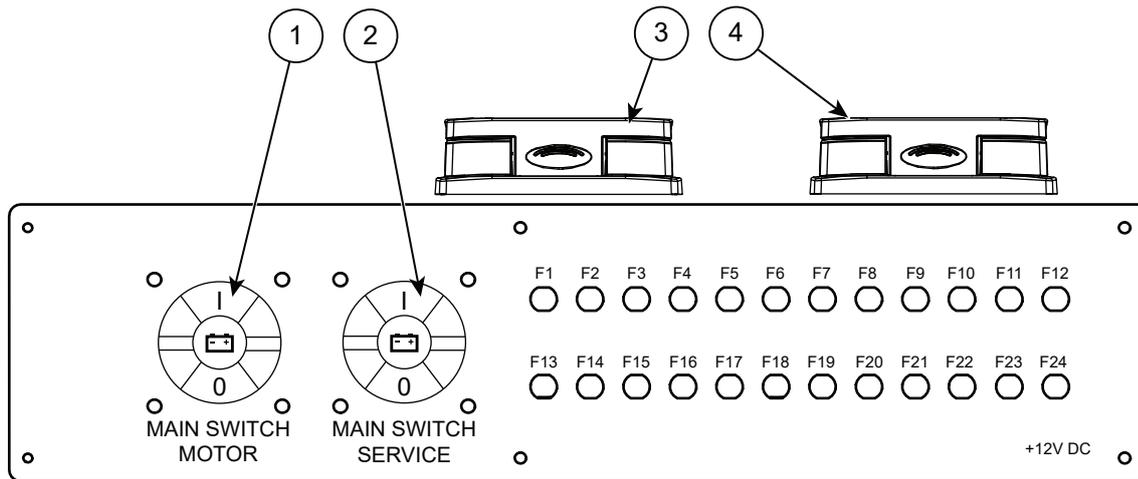
Abbildung 8.1 Yamarin 67 DC Hauptschalter und Sicherungspanel
