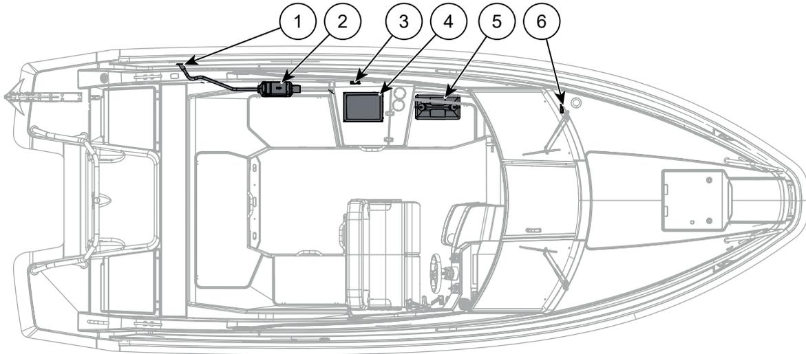
Abbildung 6.2 Yamarin 67 DC Kraftstoffbetriebene Geräte
