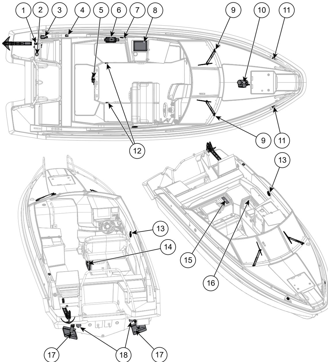
Abbildung 8.2 Yamarin 67 DC Elektrische Ausrüstung
