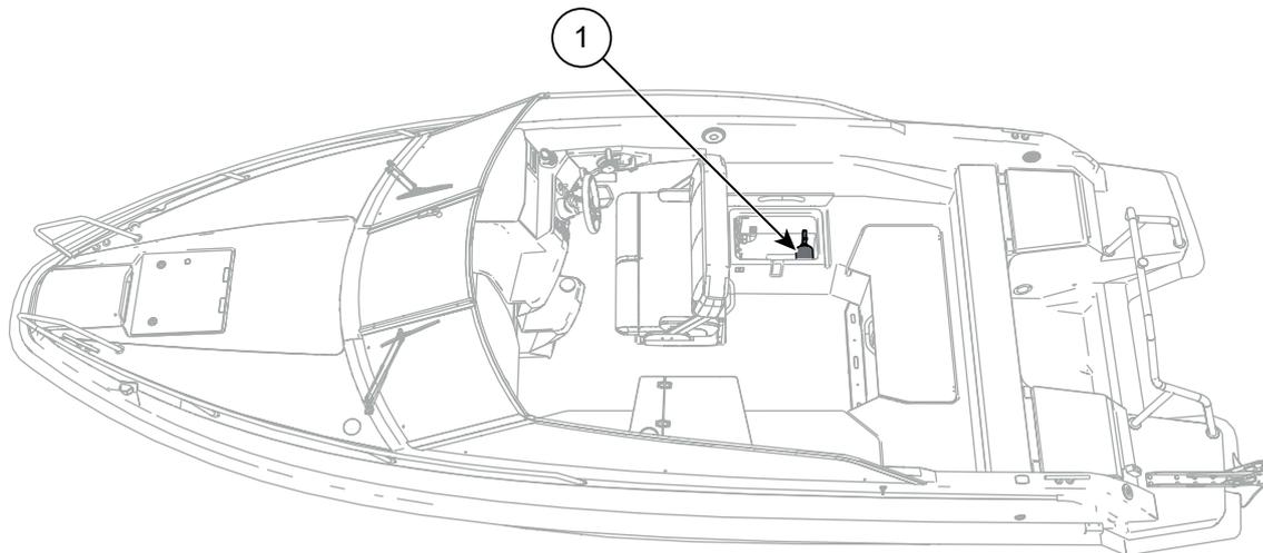
Abbildung 2.2 Yamarin 67 DC Standort des Feuerlöschers
