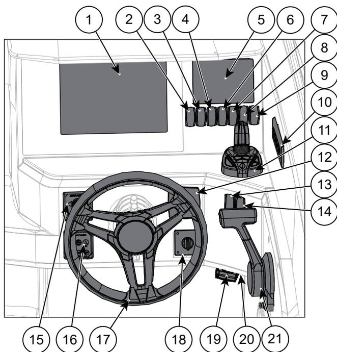
Abbildung 5.1 Yamarin 67 DC Bedienelemente am Steuerstand
