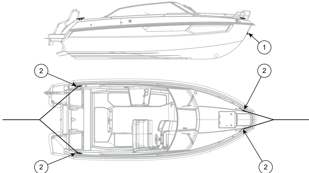
Abbildung 5.7 Yamarin 67 DC Befestigungs- und Schlepppunkte
